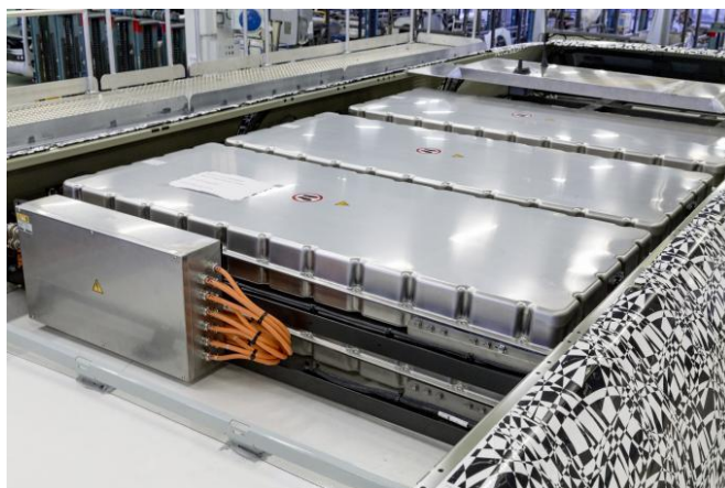
Abbildung 6: Batteriepack auf dem Fahrzeugdach Quelle: AKASOL AG
