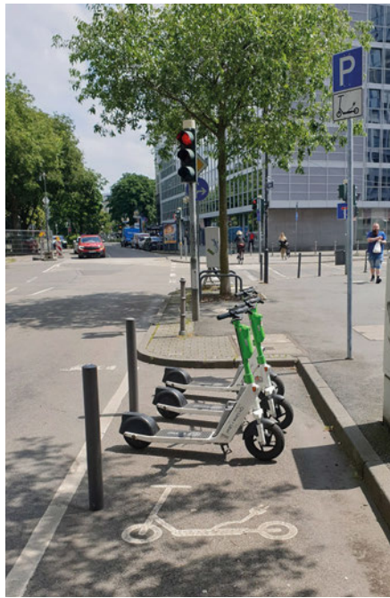
Bild 4: Mittels digitalem Geofencing wird feststellbar, ob ein E-Scooter innerhalb der Markierungen abgestellt ist. Foto: traffiQ/2024
